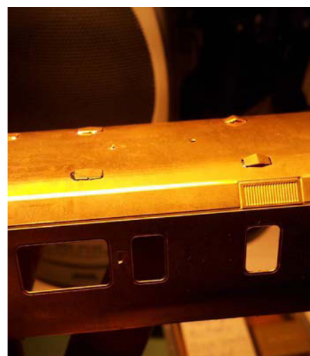
Takventilene skal kun ha en svak knekk på midten. De til høyre på bildet har for stor vinkel på brettene.
