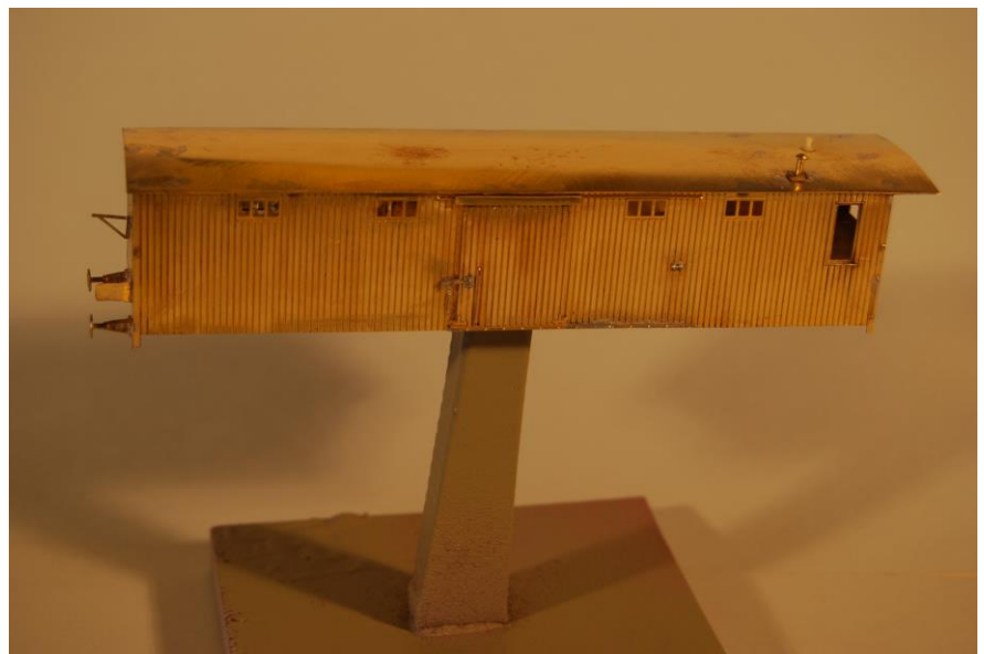
Et hjelpemiddel ved lakkering er et slikt enkelt stativ. Ha enten en rett pinne eller en T. Vognen/delene festes med små biter av tykk dobbeltvirkende tape.
