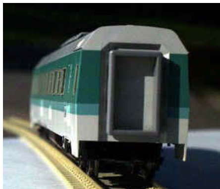
Overgangsbelgene fjernes lett fra vognkassen og passer rett inn i endeveggen til byggesettet!
